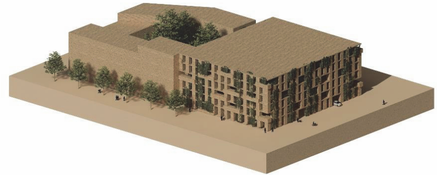
Pysäköintitalojen julkisivut tehdään tuulta läpäiseviksi katujen tuuliolosuhteiden parantamiseksi.
