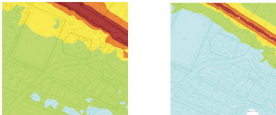
Kuva 3. Kuvassa vasemmalla melumallinnus 2040 päiväaika. Päivän melun keskiäänitaso on 50-55 dB. Kuvassa oikealla yön keskiäänitaso, joka on 45-50 dB. © Tampereen kaupunki 2019
