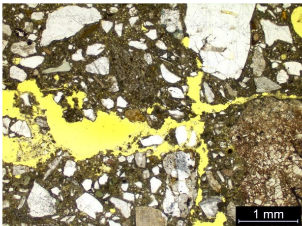
Kuva 11. Pinnan suuntainen ja pinnan vastainen halkeama lähellä ulkopintaa. OPL
