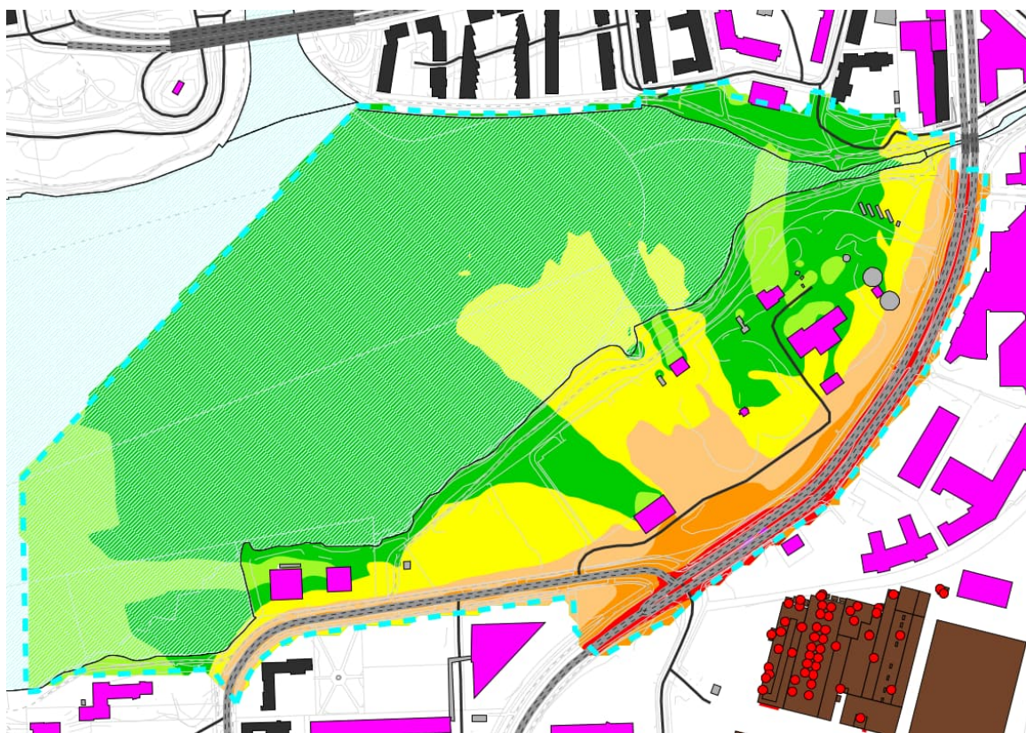
Kuva 2. Kaava-alueen päiväajan keskiäänitasot nykytilanteessa (sis. tie- ja katu liikenteen, raideliikenteen, Tevo Lokomo Oy:n teollisuusmelun)
