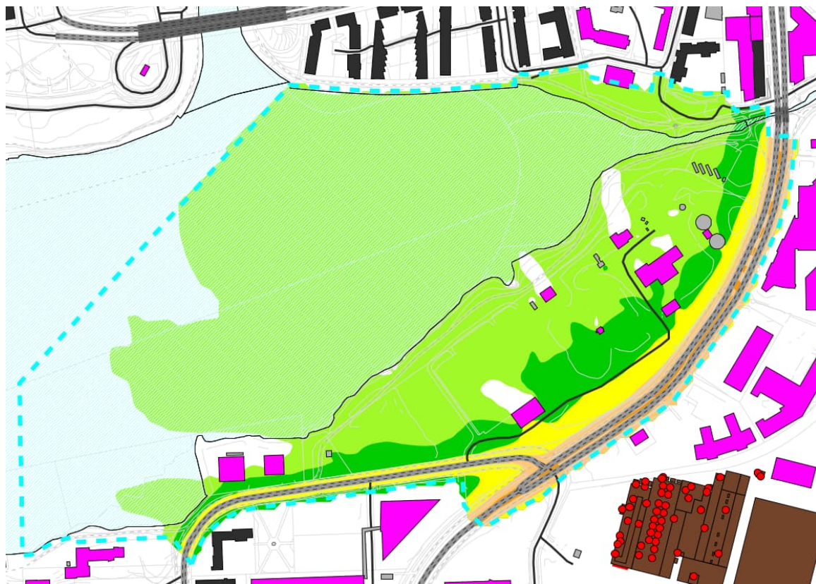
Kuva 3. Kaava-alueen yöajan keskiäänitasot nykytilanteessa (sis. tie- ja katuliikenteen, raideliikenteen, Tevo Lokomo Oy:n teollisuusmelun)
