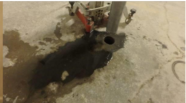
Rakenneavauksessa, VP2, neste mustaa ja öljyn hajuista
