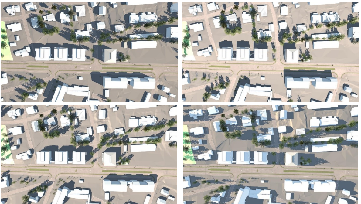
Kuva 10: Varjostustarkastelu 3D-mallin avulla tilanteissa 20. heinäkuuta klo 9, 12, 15 ja 18.
