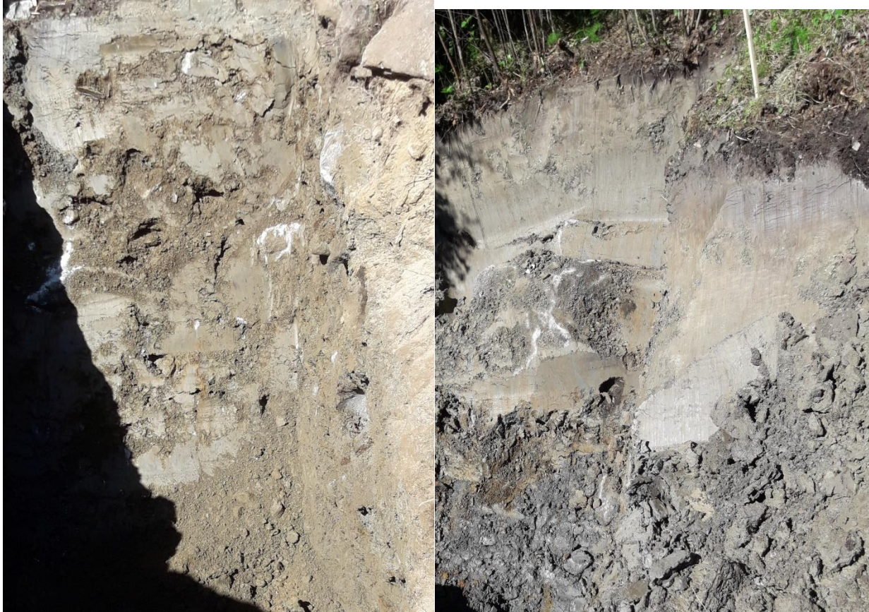
Kuva 3 Koekuopat näytepisteessä 2 (vas.), moreenivaltainen piste, ja 4 (oik.) pääosin hienojakoisia lajituneita maalajeja.
