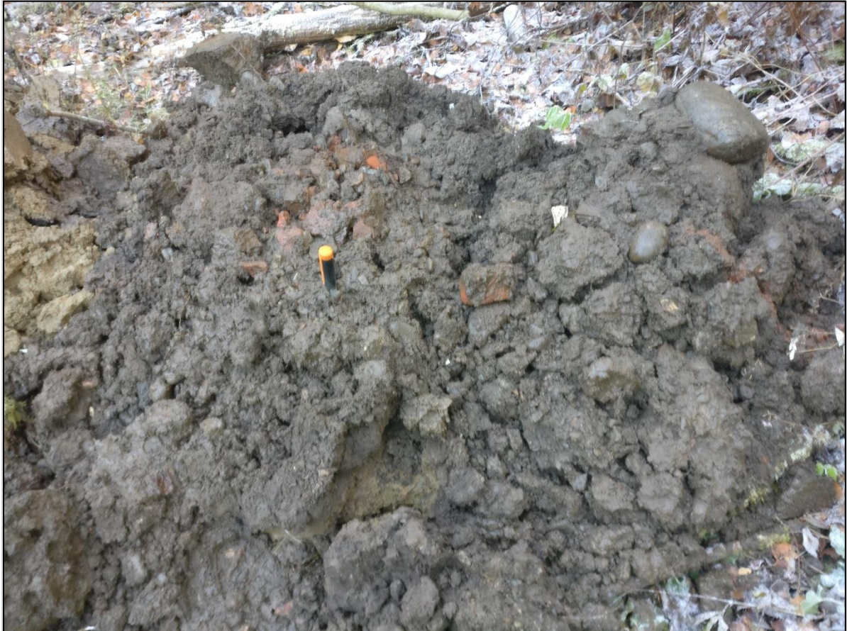
Kuva 3. Tutkimuspisteessä KK6 on puolen metrin paksuinen tiiltä ja lasia sisältävä savitäyttökerros luonnonmaaperän (hiekkä) yläpuolella.
