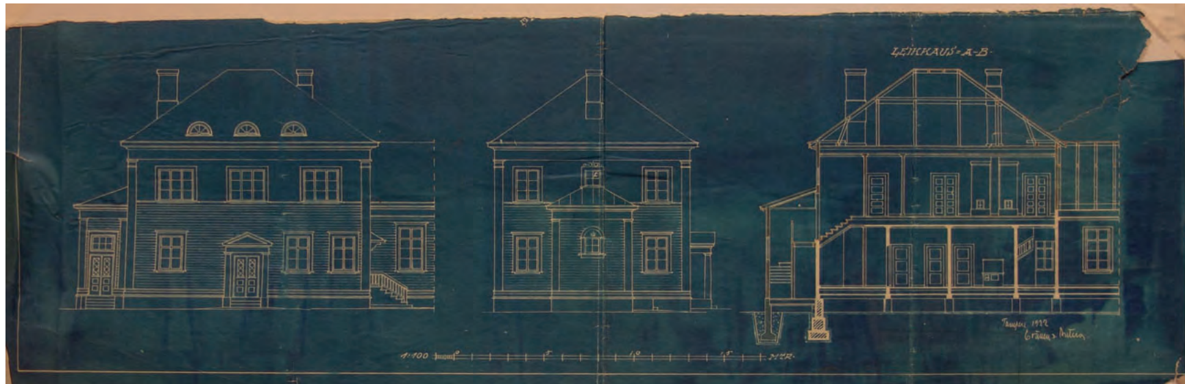
Korotuksen piirustukset vuodeltal 1922, Eränen & Autero. Piirroksiss ei ole esitetty koko rakennuksen pohjapiirustusta. Tiitolan vuoden 1906 laajennus erottuu kuvassa erilaisina ikkuna- ja verhoustyyppeinä.
