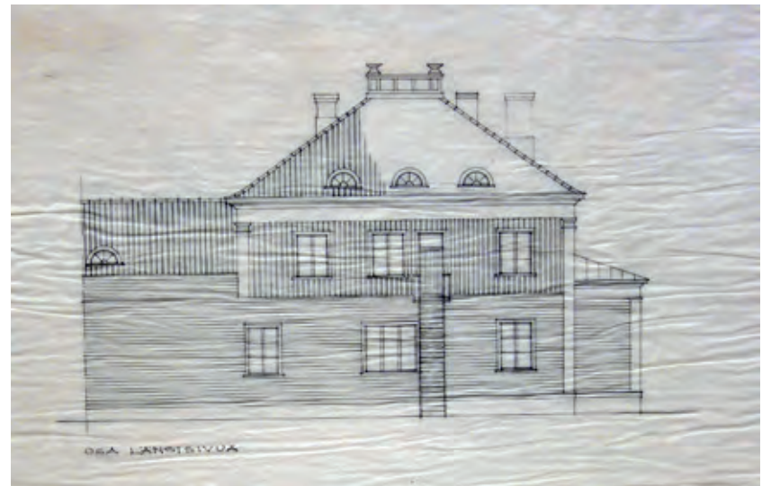
1965 muutospirustukset, Jaakko Ilveskoski. Muutoksissa alakerran asunto muutettiin neuvolatoiloiksi ja toisen kerroksen asunnosta tehtiin opetustiloja. Opetustilojen hätätieksi rakennettiin ulkopuoliset teräsportaat takajulkisivulle.
