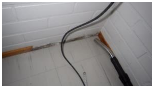
Kuvat 22 a ja b. Ala-asteen käytävien väliseinäliittymissä alapohjaan ei havaittu poikkeavaa hajua (a). Psykologin tilan ulkoseinäliittymässä ei havaittu poikkeavaa hajua (b).
