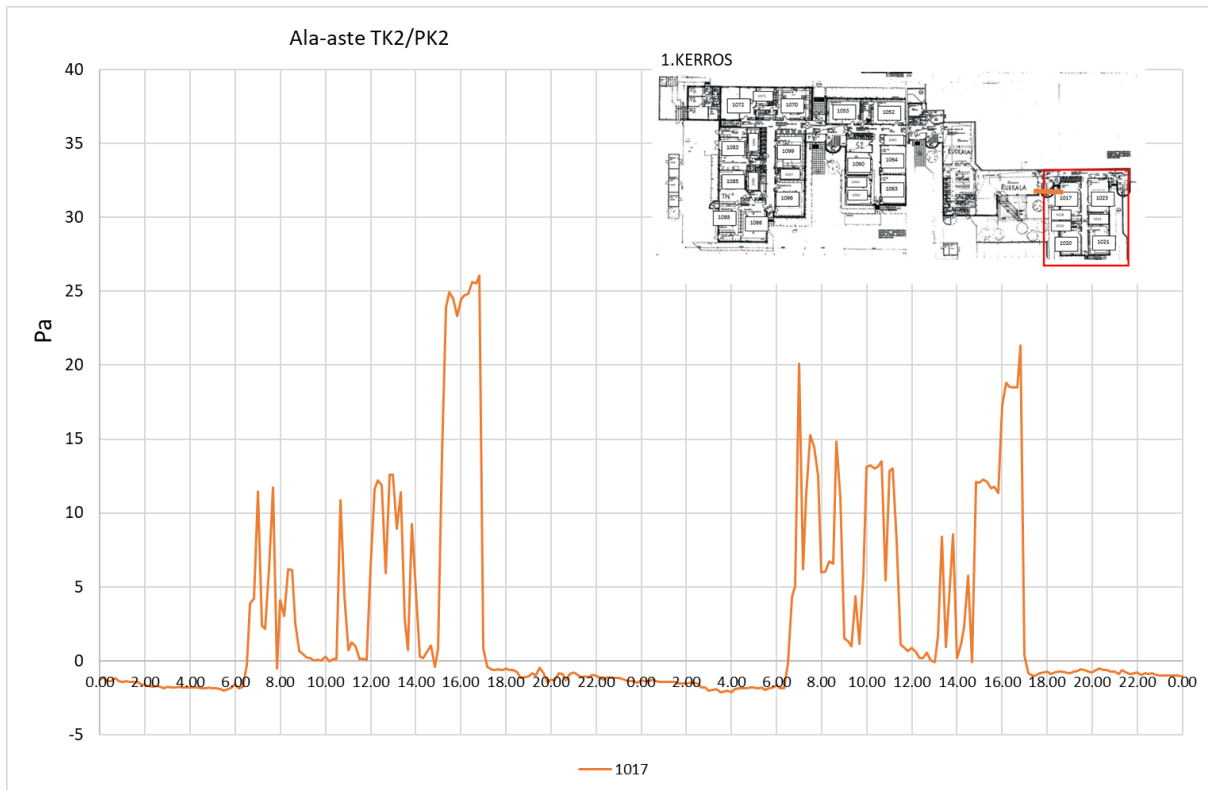
Kuva 92. Kesällä 2017 tehtyjä painesuhdemittauksia vaikutusalueilta TK2/PK2 tarkemmin kahden päivän ajalta.
