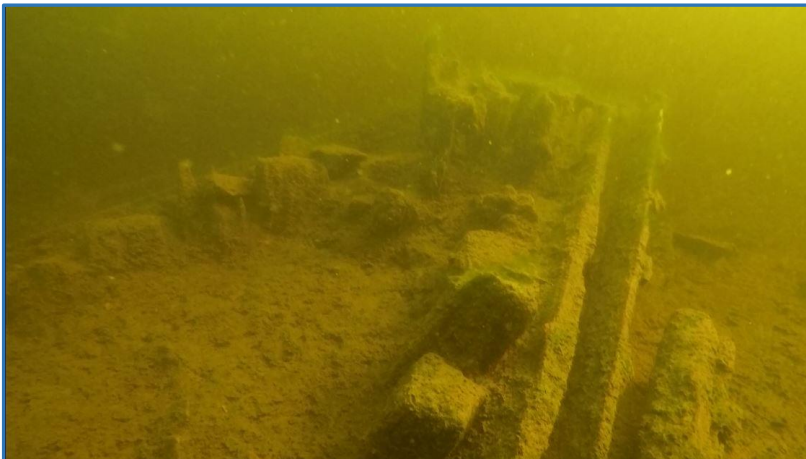
Kuva 12. Hylyn peräranka on rakennettu kolmesta puusta. Osa styyrpuurin puolen kylkeä on ratkennut irti ja makaa pohjassa hylyn vieressä. Hilyssä käytetyt rautanaulat ovat muodostaneet suuret krustit ympärilleen.
