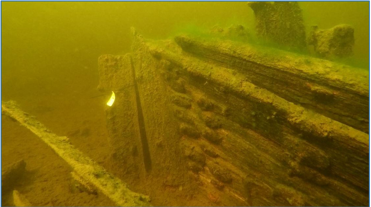
Kuva 12. Hylyn peräranka on rakennettu kolmesta puusta. Osa styyrpuurin puolen kylkeä on ratkennut irti ja makaa pohjassa hylyn vieressä. Hilyssä käytetyt rautanaulat ovat muodostaneet suuret krustit ympärilleen.
