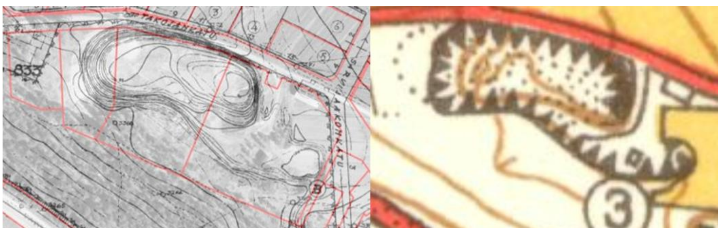
Kuva 2. Vasemmalla asemakaavakartta vuodelta 1951 (taustalla ilmakuva vuodelta 1946) Punaisella nykyiset kiinteistörajat. Korkeuskäyrät osoittavat soramontun sijainnin. Oikealla peruskartta vuodelta 1953, jossa soramontun reunat on kuvattu jyrkänteinä.
