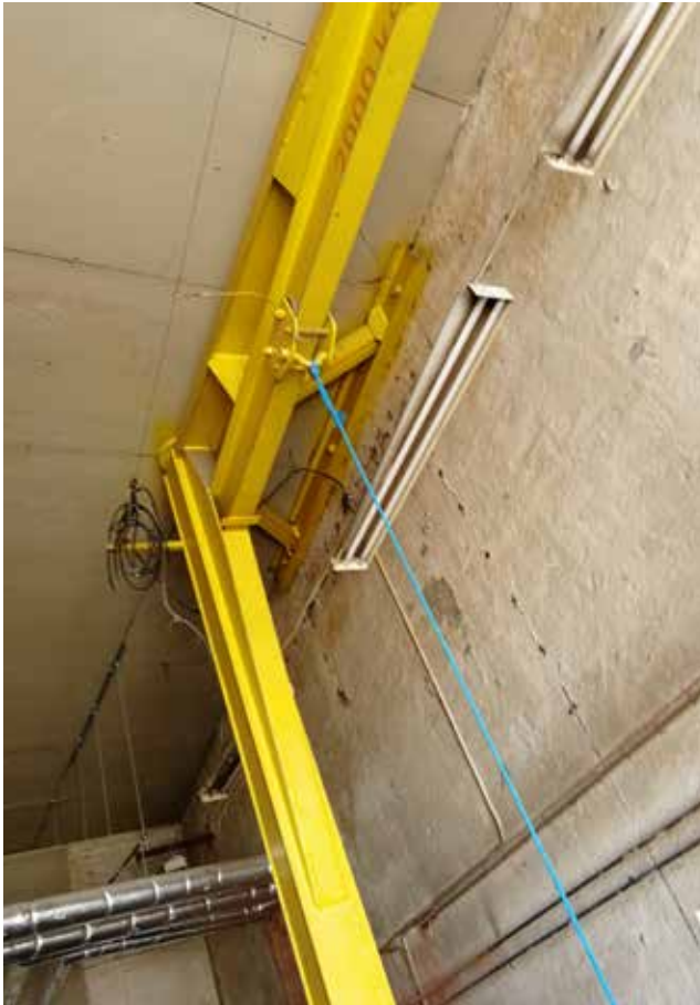
Kääntyvä pilarinosturi tukirakenteineen. Nosturi on kiinnitetty vieresen pilttuu 5:n läpi vedettyihin tukitankoihin.
