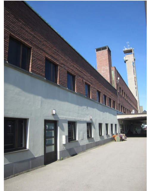
Rautatieaseman julkisivumateriaalien nelijako tiili–rappaus–klinkkeri–betoni (sekä länsijulkisivun koristeosien terastirappaus) on alkuperäinen, ja se noudatti käytännöllisiä lähtökohtia. Laiturialueen valkoisen julkisivun oli tarkoitus parantaa katoksen alaisen alueen valaistusta. Valokuvat: Panu Savolainen.
