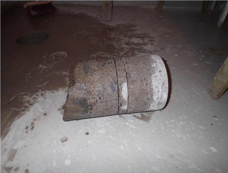
Kuva 3. Kuvassa timanttikorattu betonilattia kellarissa sekä irtiotettu pala.
