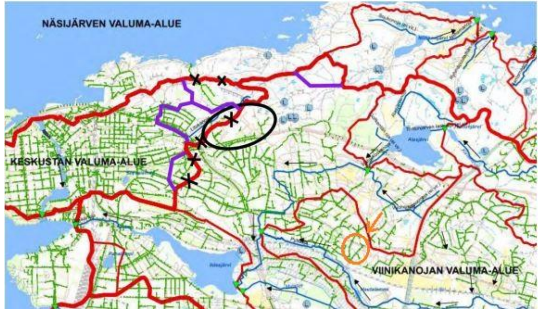
Kuva 4. Tarkistettu valuma-aluekarttaote Kaupin kampusalueen hulevesiselvityksestä. Virheelliset päävedenjakajat esitetty rasteilla. Kaavamuuosta koskeva alue merkattu oranssilla ympyrällä ja nuolella. Lähde: Kaupin Kampuksen hulevesiselvitys, Ramboll.
