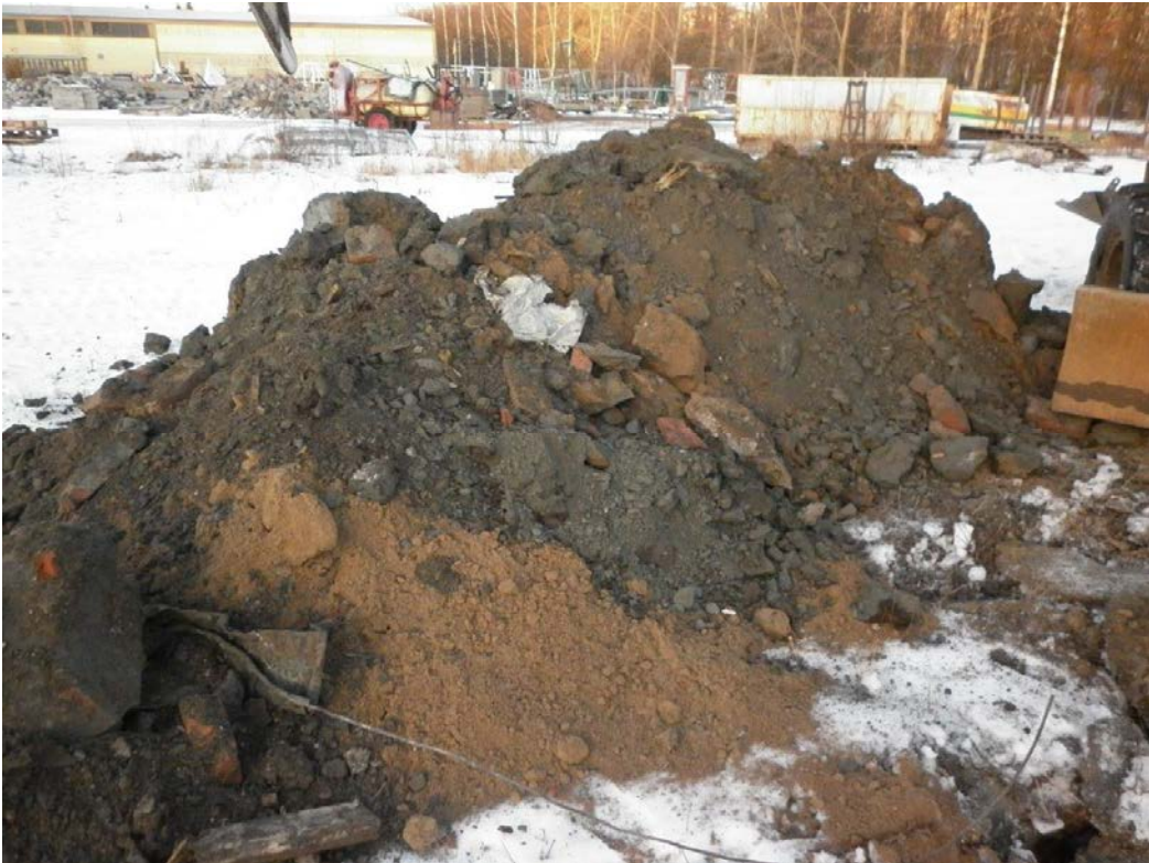
Kuva 9. Koekuopan KK4 kaivumaita, joukossa mm. tiiliä, betonia, rautaa ja muovia.
