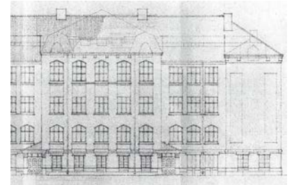
Rakennuslupapiirustus 1950-luvun korjauksesta, jossa katto muutettiin.
