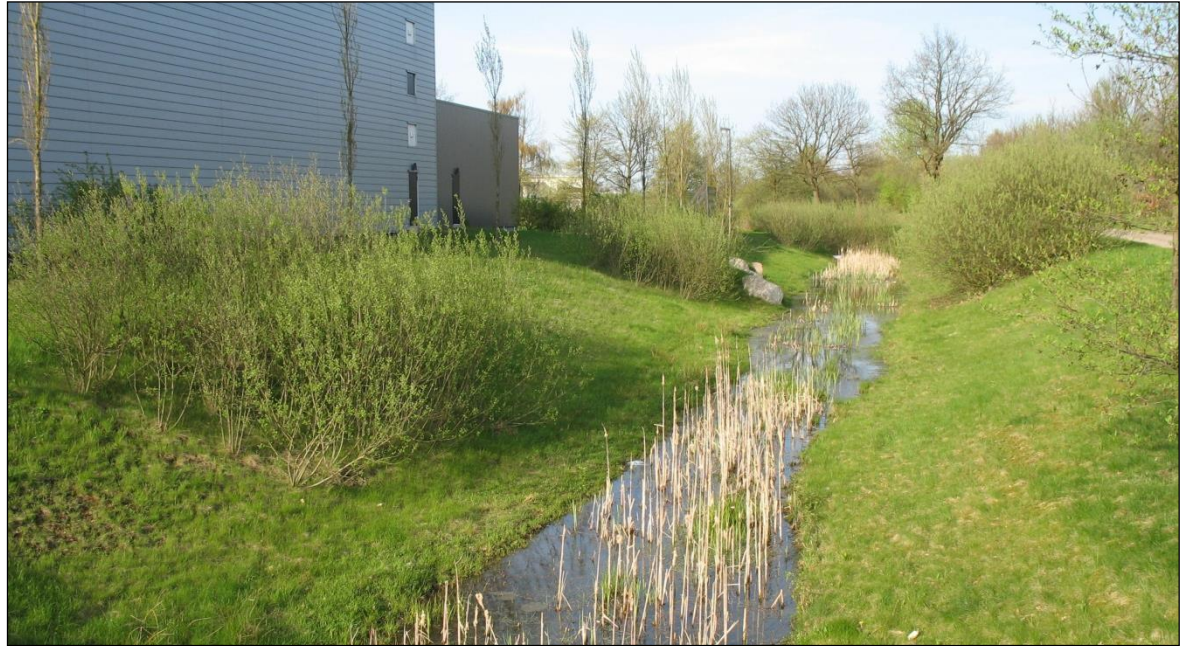
Kuva 14. Esimerkki viivytykspainanteesta teollisuusalueella. Suuremman tulva-alueen aikaansaamiseksi painanteet tulisi muotoilla kuvassa esitettyä loivapiirteisemmiksi mikäli tilavaraus ja korkeusasemat sen sallivat. Kosteikkokasvillisuuden osuus voisi olla kuvassa esitettyä suurempi. 9
