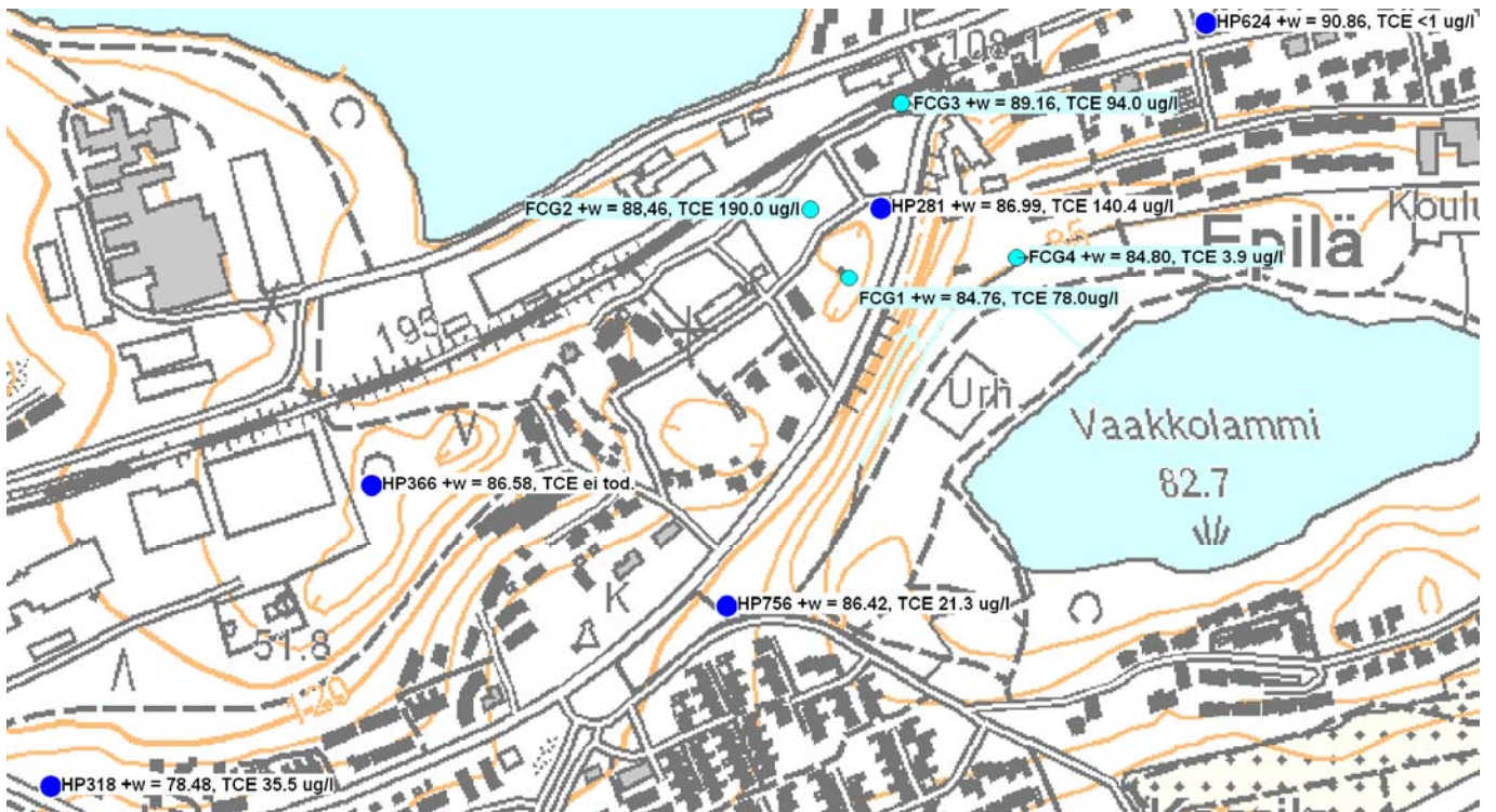
Kuva 7. Uudet havaintoputket FCG1 – 4, vedenpinnantasot ja TCE-pitoisuus
