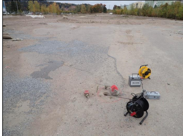
Kuvat 9 ja 10. Pohjavesinäytteenottoa pisteillä FCG11 (kuva 9) ja FCG9 (kuva 10)
