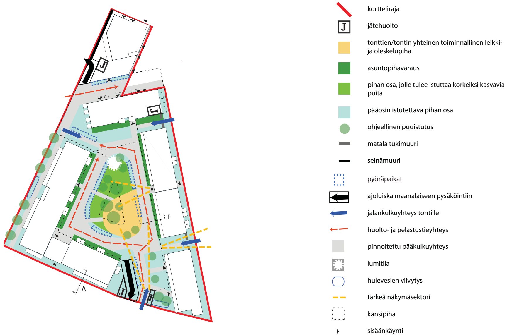
kuva 11. Kaavio piha-alueiden toiminnallisesta järjestelystä.
