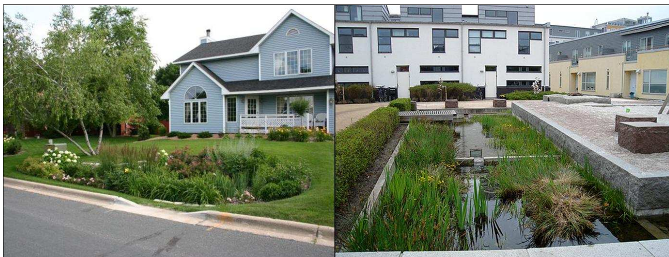
Kuva 11. Esimerkkejä sadeputarhoista piha- ja kattovesille 11,9
