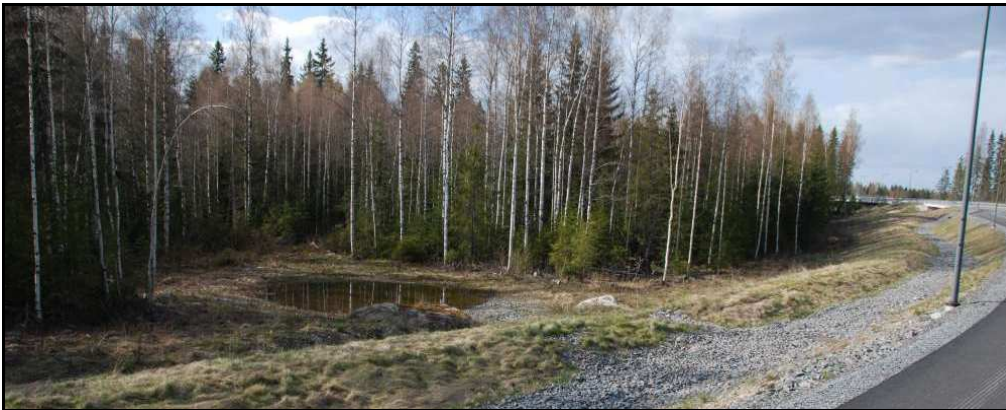
Kuva 5. Noro 4 alkaa Vuoreksen puistokadun länsipuolelta noin 200 m Särkijärvestä etelään. Koh- taan on rakennettu katualueen hulevesiä viivyttävä painanne. Noron valuma-alueen latvat sijaitse- vat Vuoreksen puistokadun itäpuolella Suolijärven länsipuoleisella harjanteella. 5
