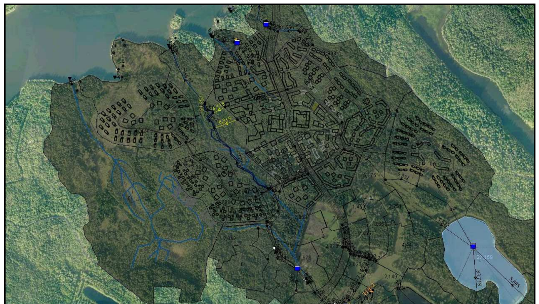
Kuva 17. Ote suunnittelualueesta rakennetusta SWMM-hulevesimallista.
