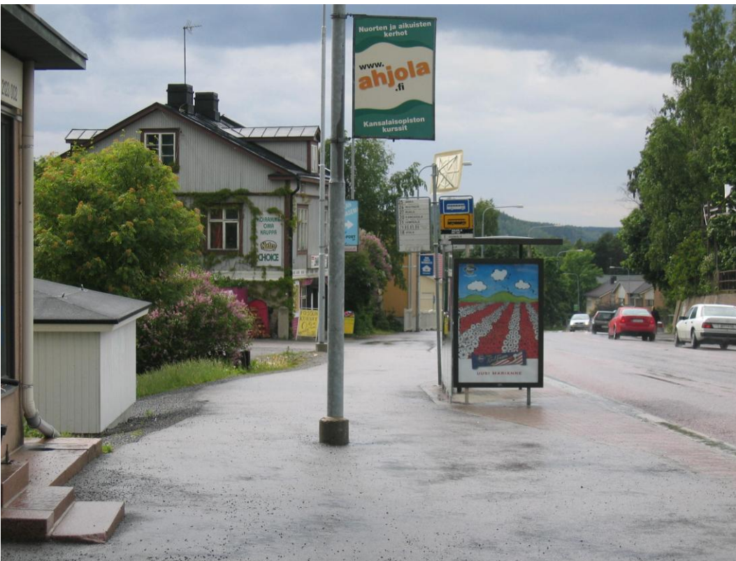
Kuva 3.10. Valopylväs keskellä kevyen liikenteen väylää.
