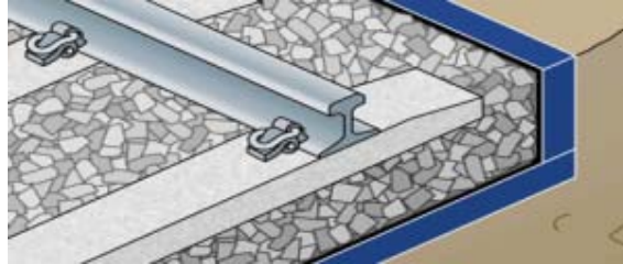
Kuva 9. Ratarakenteisiin asennettu runkomelumatto (esitettyinä sinisellä värillä).
