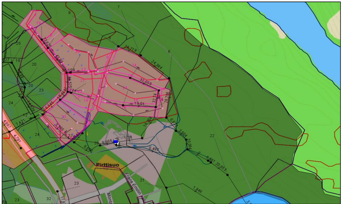
Kuva 11. Ote koko Vuoreksen kattavasta, FCG:n laatimasta SWMM-hulevsimallista, johon on päivitetty Isokuusen II vaiheen asemakaavan mukainen maankäyttö. (Pohjakartta Eniro Maps)
