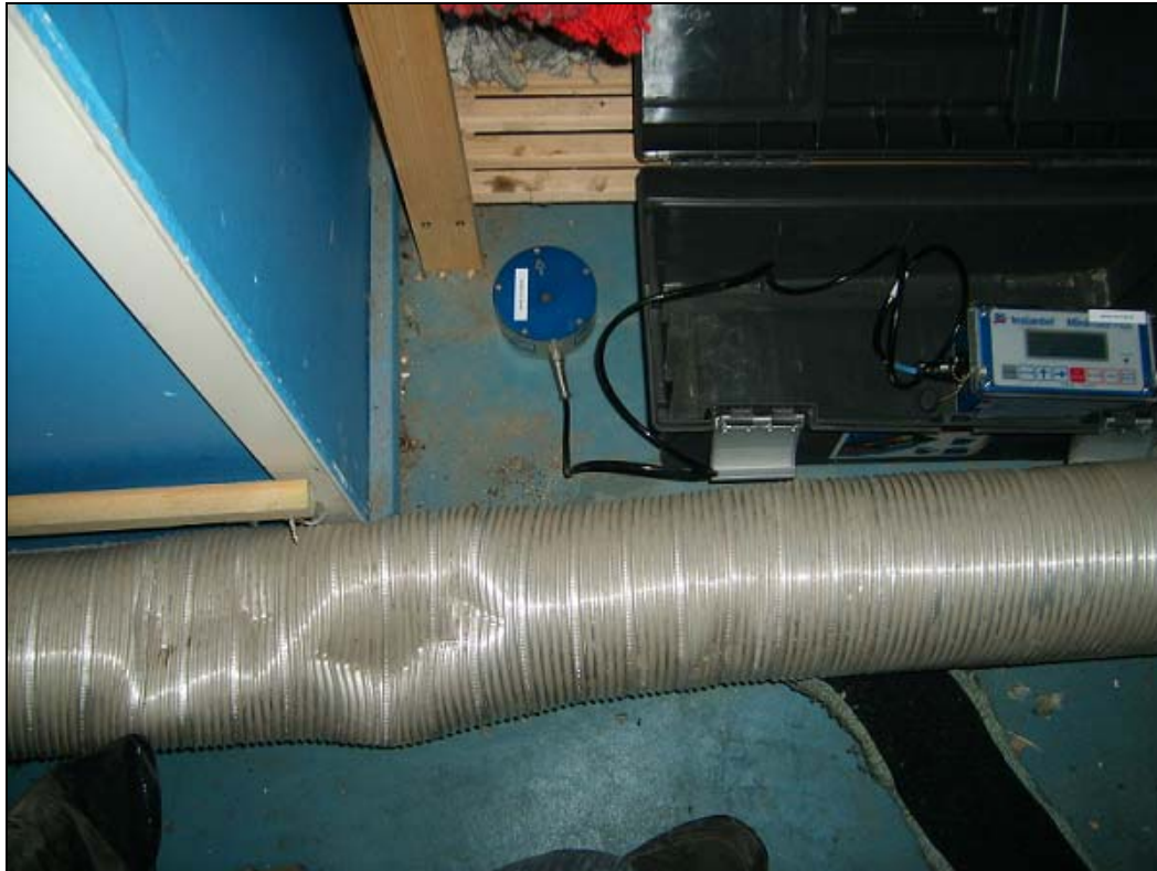
Kuva 2. Tärinämittari rakennuksen sisällä
