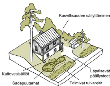
Kuva: Hulevesien hallinta tontilla (Rakentamistapaohje)
