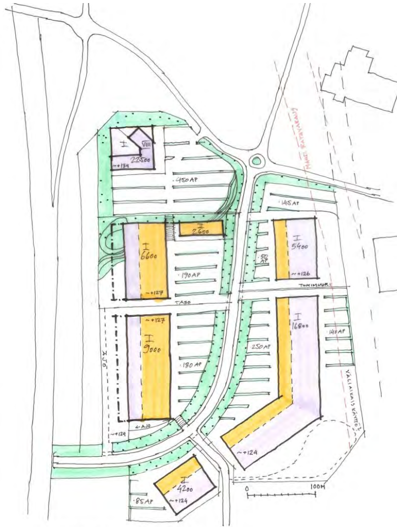
MALLI 2 Kerrosala yhteensä 67 100 kem 2 1pp/50 m 2 maantasopaikoitus TAMPEREEN KAUPUNKI MYLLYPURON KOLMENKULMAAN ASEMAALUEA S183 Korttelien 3587,3588 ja 3589 Toteuttamismalli 2. Asemapiirros. 3.6.2014 PTS/TVu WSP FINLAND OY
