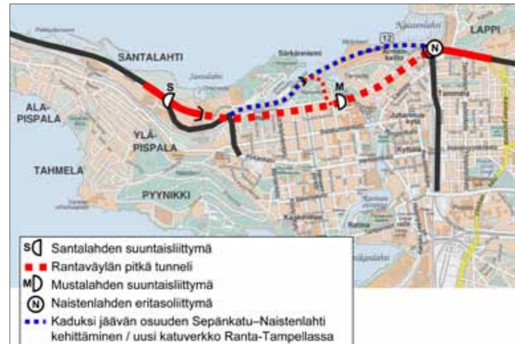
Kuva 3.19. Vaihtoehdon 2 kehitysvaihtoehto 2B: tunnelin keskellä on suuntaisliittymä itään ja Santalahdessa ei ole rampeja tunneliin.
